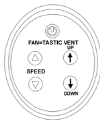
Attic Fan Control
